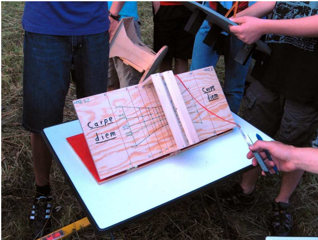
Sonnenuhren mit stumpfen Stößen verleimt & geschraubt Kiefersperrholz & Fichte(Klasse 9)
