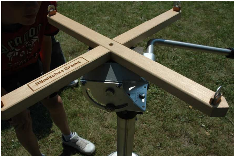
Römische Groma mit 90° Überblattung (verleimt) aus Hartholz & CNC-Fräsung (Klasse 8)
