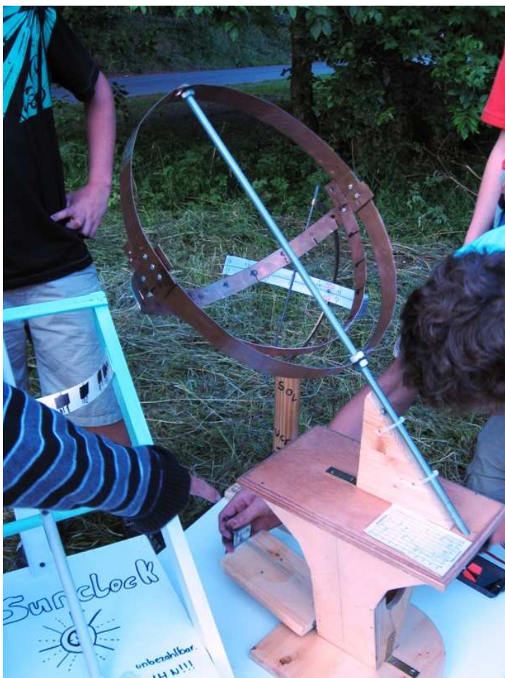
Sonnenuhr aus Kupferblechstreifen genietet & Gewindestahl sowie & Kiefer-Sperrholz stumpf gestoßen & geschraubt (Klasse 9)
